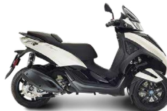
Il Piaggio MP3 Yourban Sport 300 vanta leggerezza e compattezza. Gli elevati standard di sicurezza sono garantiti dal doppio pneumatico anteriore che assicura allo stesso tempo agilità e alta stabilità di guida.
